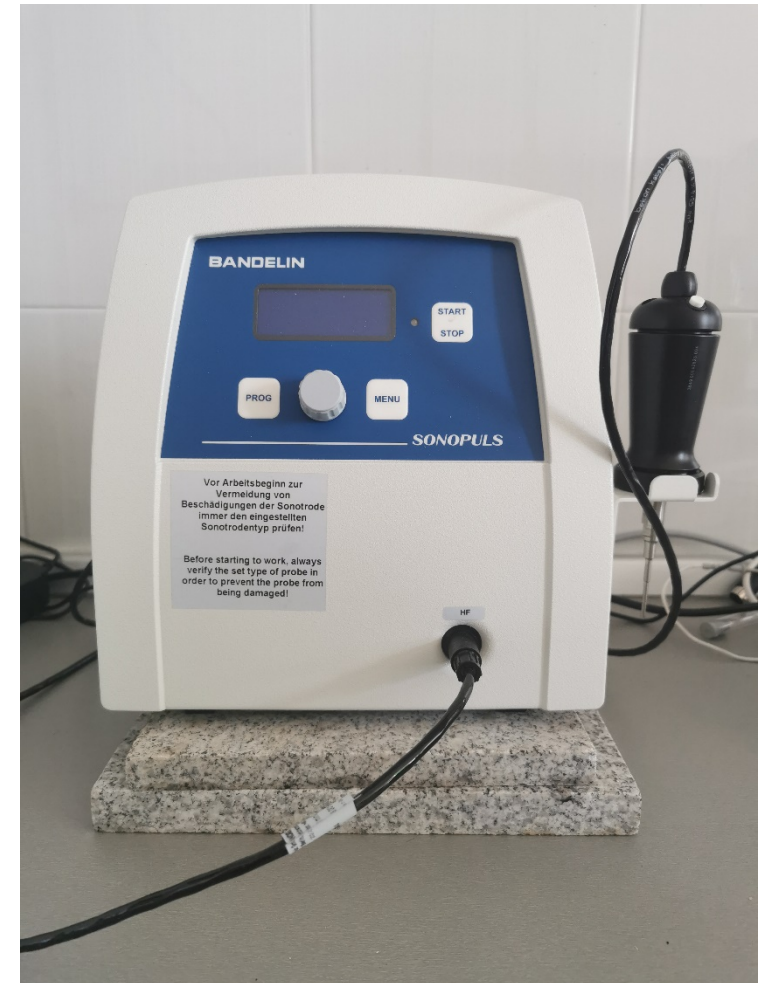
Ultrazvučna sonda Sonoplus mini 20 (Badelin, Germany) 45 min, 75% Amplitude
